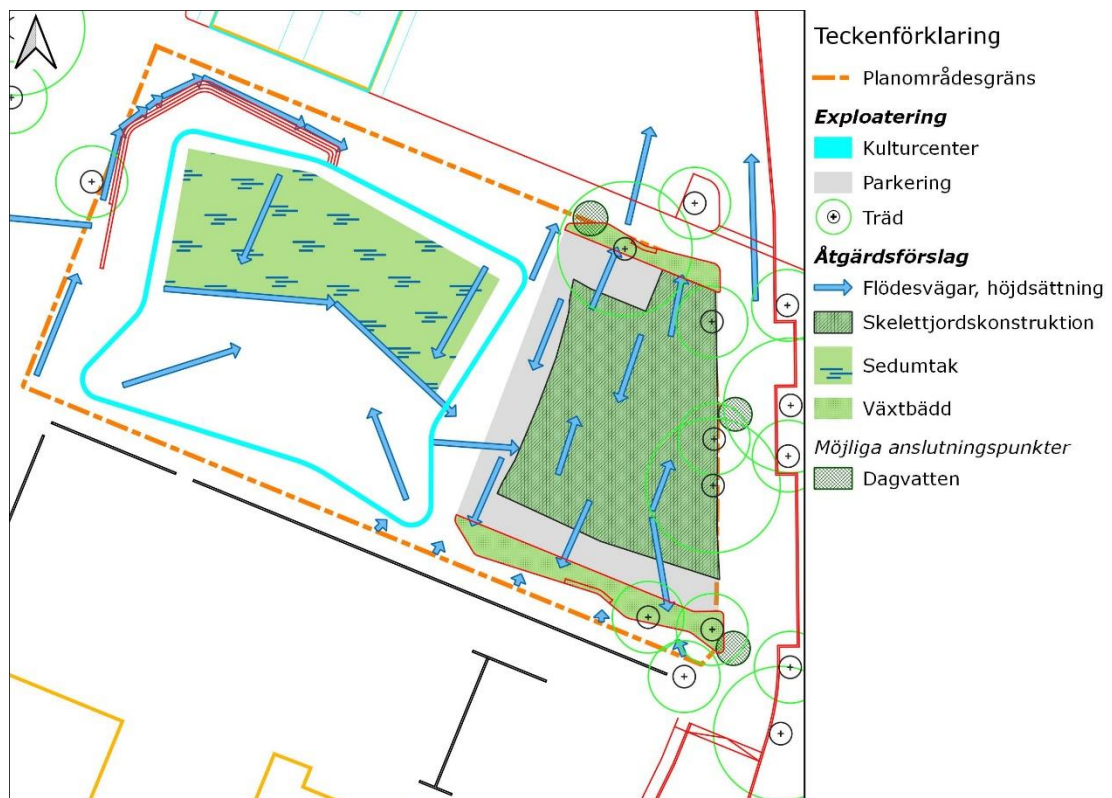
Figur 14. Skiss över föreslagna systemlösningar för dagvattenhanteringen tillsammans med schematisk skiss av planerad exploatering och sedumtak. Teckenförklaring finns i bilden.
