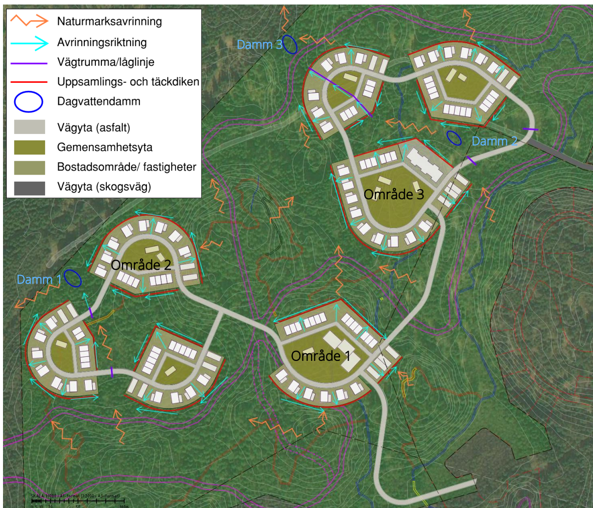
Figur 13. Avvattningsplan för utredningsområdet. Röda linjer och bågar markerar placering av uppsamlingsdiken och blå ovaler markerar placering av dagvattendamm. Ljusblå pilar visar ungefärlig riktning för avrinning och pilar i orange visar naturmarksavrinningen.
