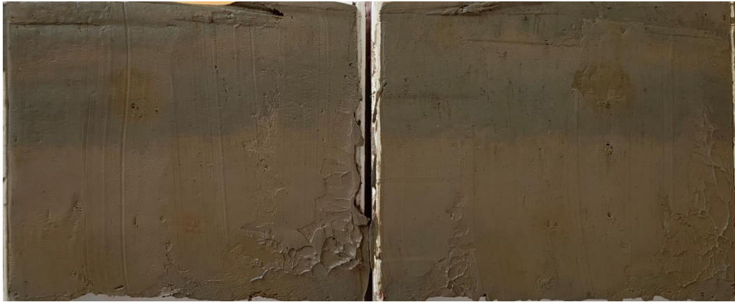
Figur 1 Borrpunkten, BG20010, 3,25 m, Jordprovet i övre delen av mellanhylsan delad longitudinellt provhylsan med id 17.
