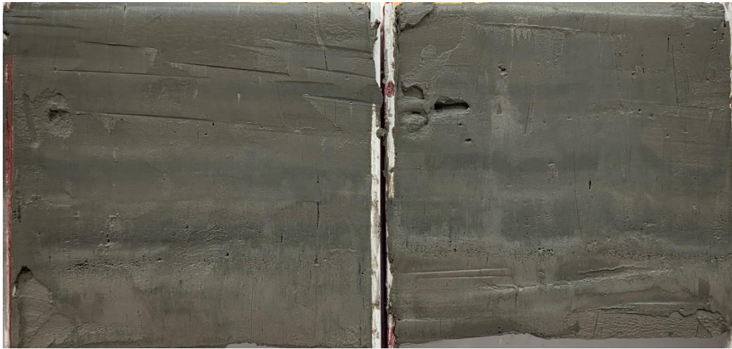
Figur 2 Borrpunkten, BG20010, 4,25 m, Jordprovet i övre delen av mellanhylsan delad longitudinellt provhylsan med id TBS 133.
