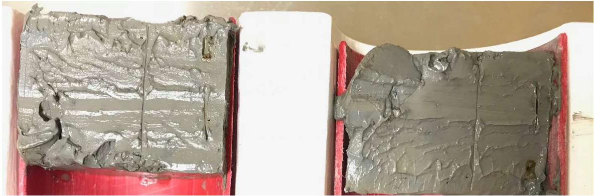
Figur 1 Borrpunkten, BG19003, 1,8 m, Jordprovet i övre delen av mellanhylsan delad longitudinellt provhylsan med id Bjerking 432
